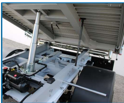
Benne basculante et faux-châssis entièrement en alliage structural d'aluminium.
