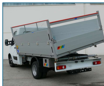
Rehausses pleines en aluminium ou grillagé en acier galvanisé à chaud disponibles en opt.
