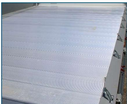
Surface du plancher en aluminium lisse ou antidérapante, idéale pour les charges concentrées et les substances corrosives, disponible en OPT.
