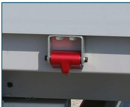
Pivots latérales en aluminium avec crochets pour cordes, standard.
